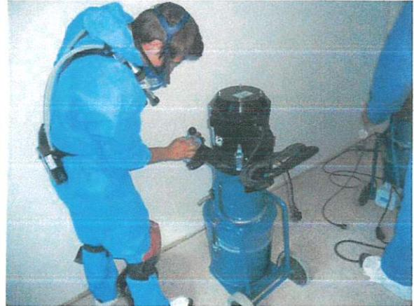
Abbildung 59: Feuchtes Abwischen der Maschinen
