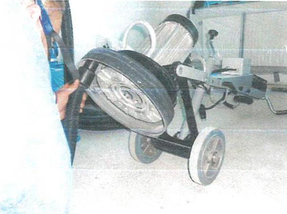
Abbildung 60: Absaugen der Schleifscheibe
